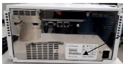
Рисунок 2 – Место нанесения маркировочной таблички и серийного номера хроматографов жидкостных 1260 Infinity III
