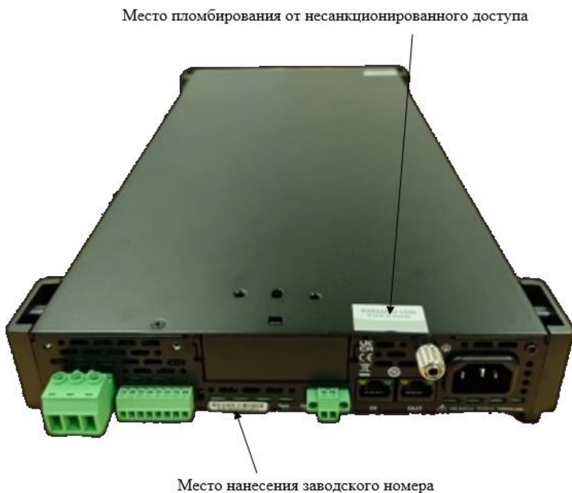
Рисунок 2 – Место нанесения заводского номера и место пломбирования от несанкционированного доступа источников питания постоянного тока двунаправленных IT-M3400
