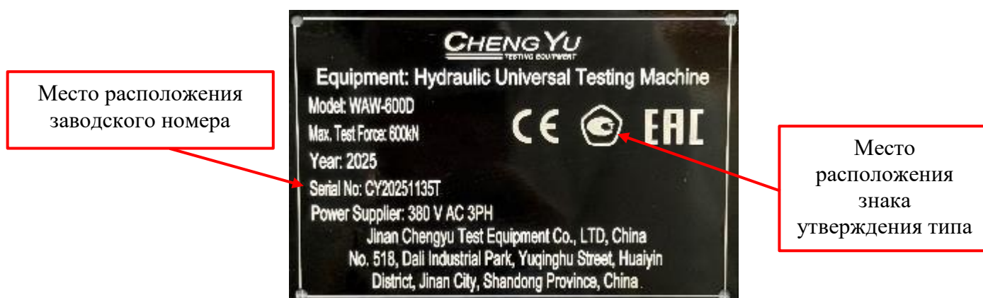
Рисунок 2 – Общий вид маркировочной таблички с местом расположения заводского номера и знака утверждения типа
