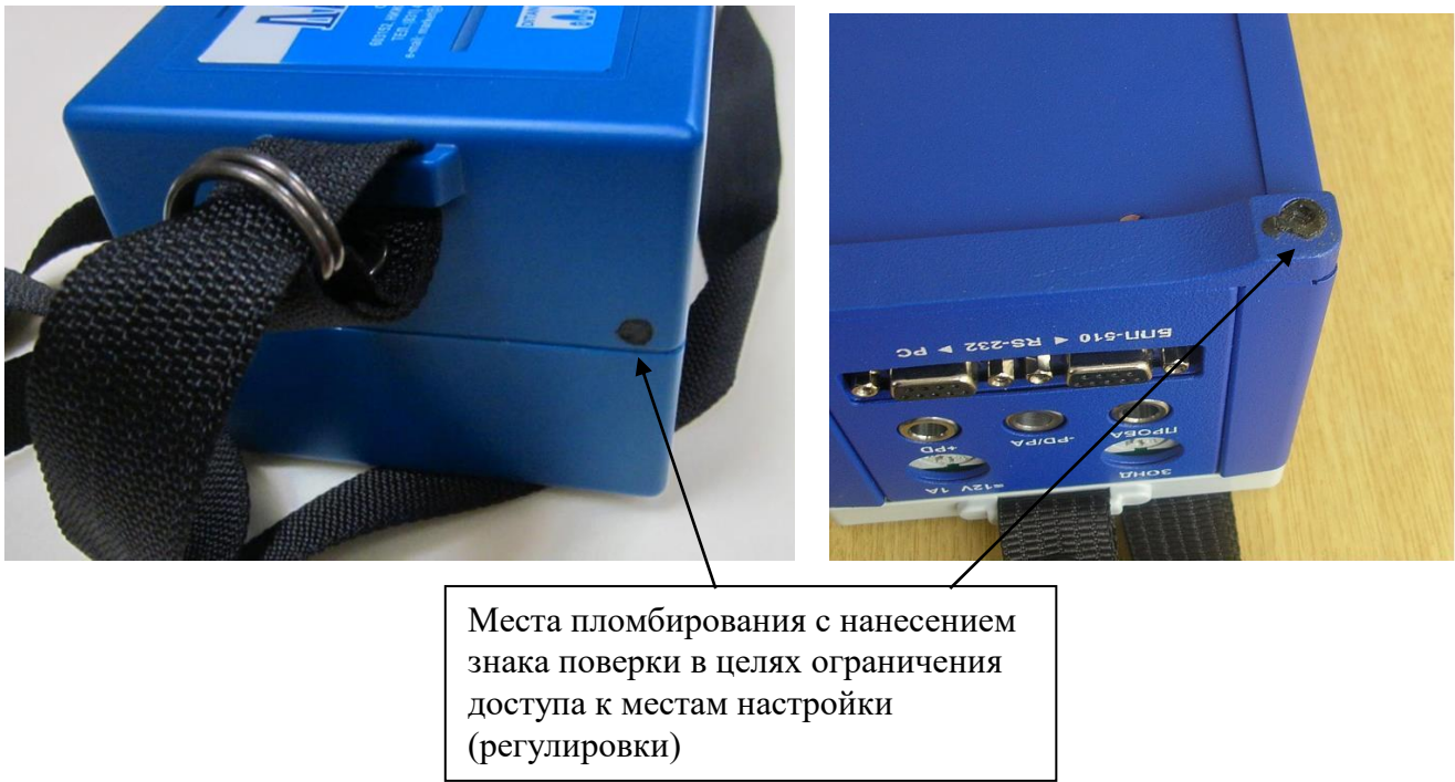
Рисунок 2 – Места нанесения мастичных пломб с изображением знака поверки
