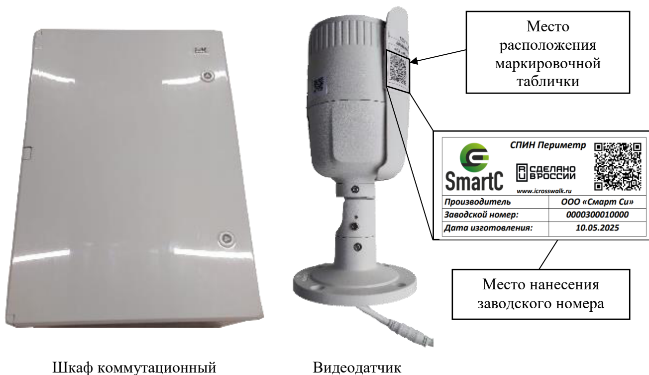
Рисунок 1 – Общий вид шкафа коммутационного и видеодатчика, входящих в состав Систем, место расположения маркировочной таблички и заводского номера на видеодатчике
