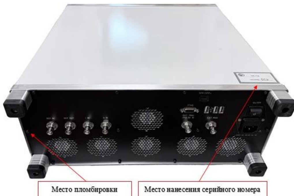
Рисунок 2 – Схема пломбировки от несанкционированного доступа
