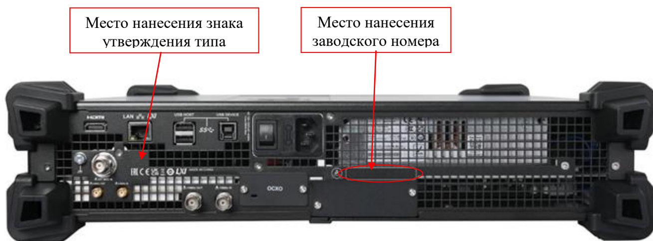
Рисунок 2 – Общий вид генераторов, задняя панель
