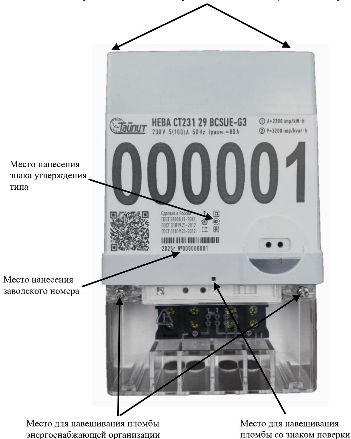
Рисунок 4 – Общий вид счетчиков исполнений HEBA CT231 с указанием мест нанесения заводских номеров, знака утверждения типа, а также мест пломбирования
