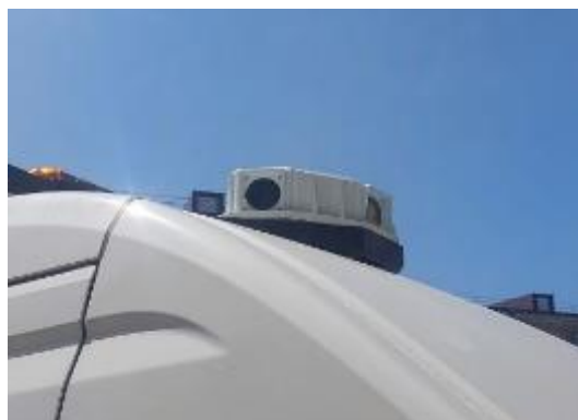
Рисунок 11 – Система видеосъемки РДТ-803 с камерами в едином корпусе канала «видеосъемка»
