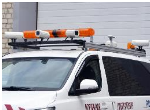
Рисунок 10 – Система видеосъемки РДТ-696.Н5 с 5-ю наружными камерами канала «видеосъемка»
