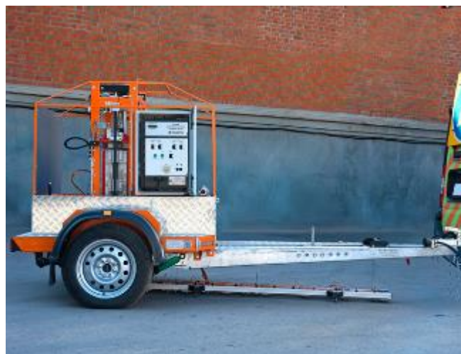
Рисунок 23 – Установка динамического нагружения «Прогибомер FWD-RDT» канала «прочность»
