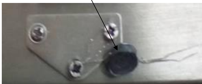
Рисунок 3 – Схема пломбировки от несанкционированного доступа и обозначение места нанесения знака поверки индикатора СТТ-А
