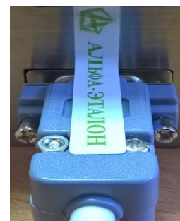
Рисунок 4 – Схема пломбировки от несанкционированного доступа, обозначение мест нанесения знака поверки
