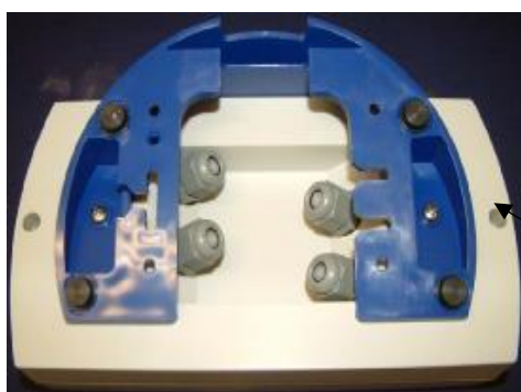
Рисунок 8 – Схема пломбировки от несанкционированного доступа и обозначение места нанесения знака поверки индикатора CTT-DIGITAL
