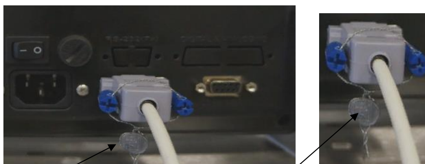
Рисунок 5 – Схема пломбировки от несанкционированного доступа и обозначение места нанесения знака поверки индикатора СТТ
