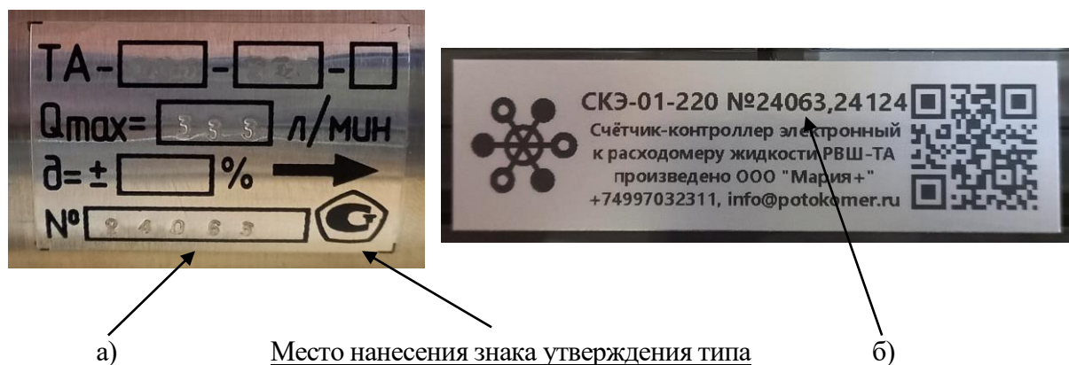
Рисунок 3 – Схема нанесения заводских пломб и обозначение места нанесения знака поверки
