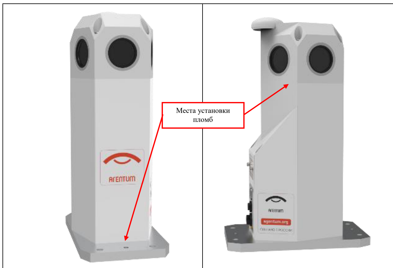
Рисунок 1 – Общий вид панорамной камеры и схема пломбировки от несанкционированного доступа
