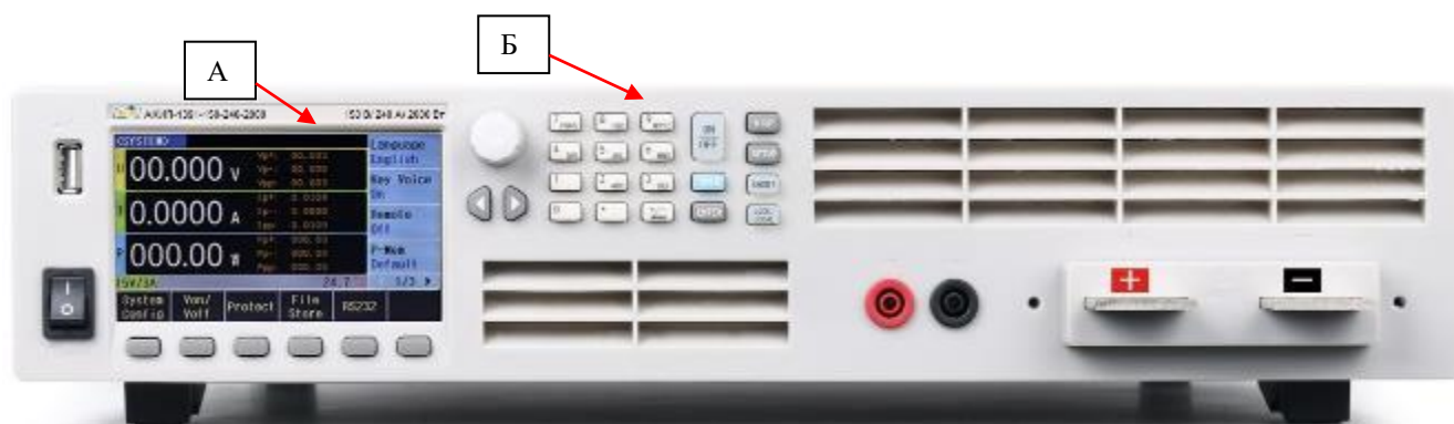
Рисунок 3 – Общий вид нагрузок АКИП-1391-150-120-1000, АКИП-1391-150-180-1500, АКИП-1391-150-240-2000 с местами нанесения знака утверждения типа (А) и знака поверки (Б)
