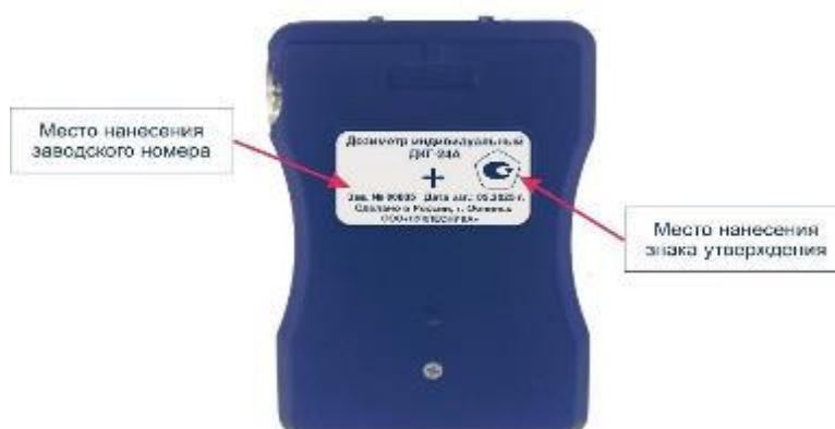
Рисунок 2 – Место нанесения знака утверждения и заводского номера на ДКГ-24А
