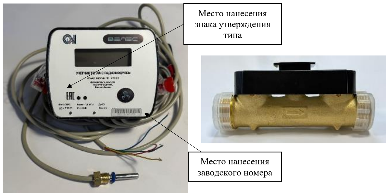
а) вычислитель с термопреобразователями сопротивления
