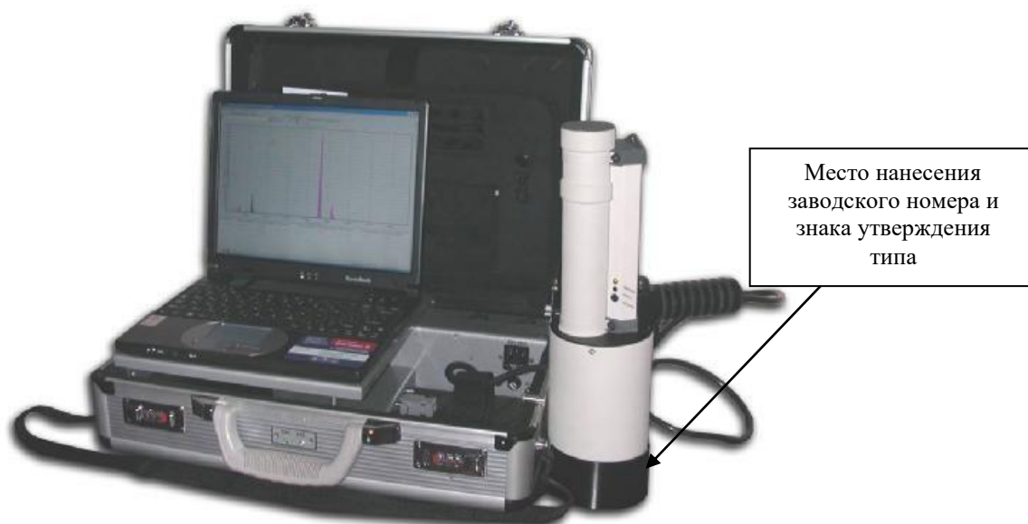
Рисунок 1 – Внешний вид анализаторов рентгенофлуоресцентных энергодисперсионных «Призма - M(Au)» в переносном варианте исполнения
