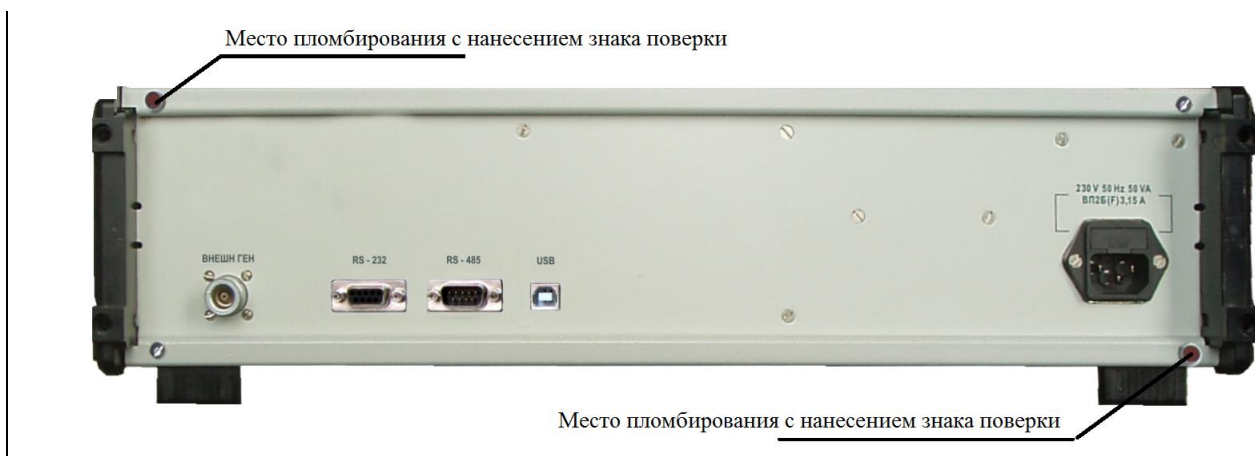
Рисунок 2 – Схема пломбирования от несанкционированного доступа.
