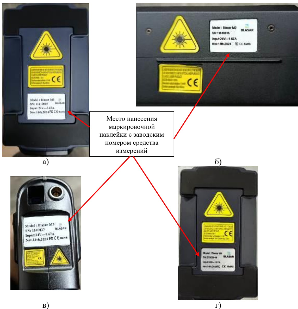
Рисунок 2 – Место расположения маркировочных наклеек с указанием заводского номера приборов оптических координатно-измерительных бесконтактных Blasar модификаций:
