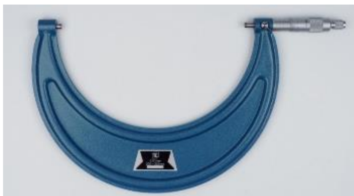
Рисунок 4 – Общий вид микрометров с отсчетом показаний по шкалам стебля и барабана
