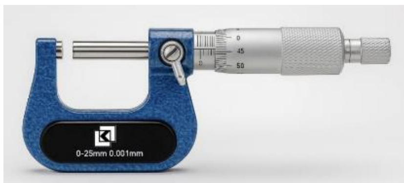
Рисунок 6 – Общий вид микрометров с отсчетом показаний по шкалам стебля и барабана с нониусом
