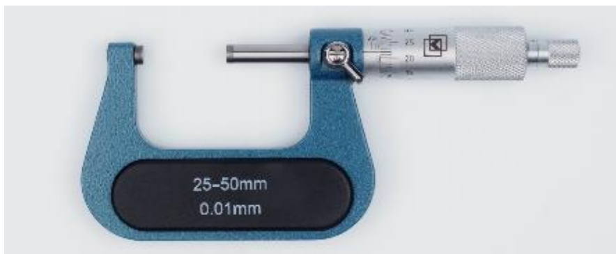
Рисунок 3 – Общий вид микрометров с отсчетом показаний по шкалам стебля и барабана
