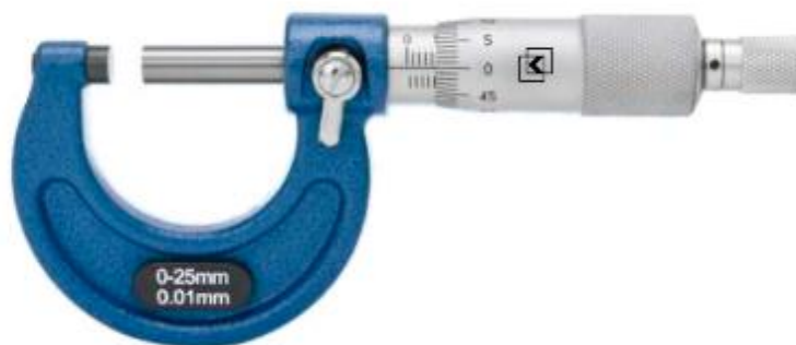
Рисунок 1 – Общий вид микрометров с отсчетом показаний по шкалам стебля и барабана
