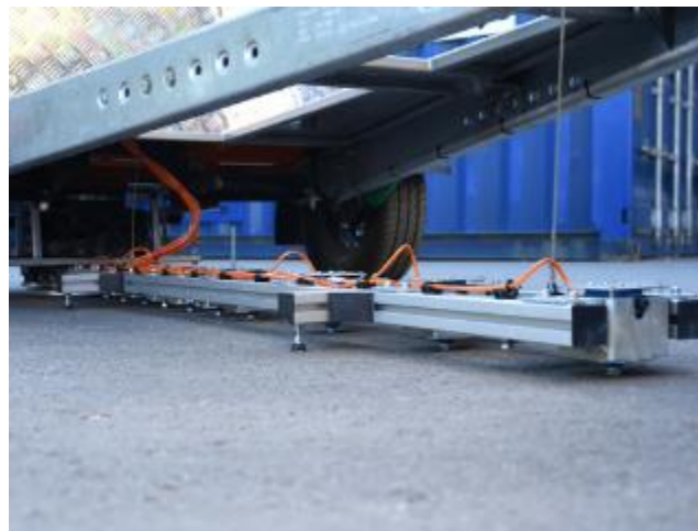
Рисунок 7 – Балка с датчиками измерений прогиба
