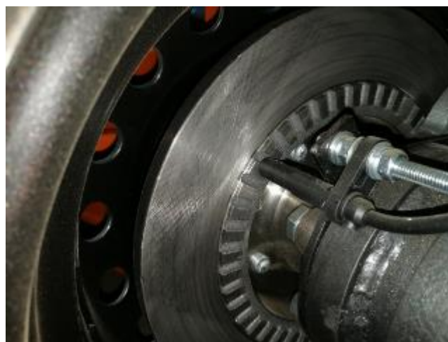
Рисунок 5 – Датчик измерений длины пройденного пути на элементах подвески колеса прицепа
