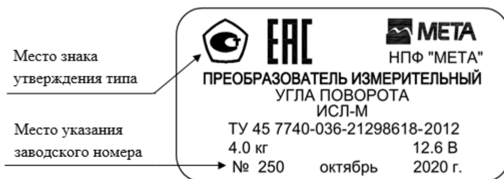
Рисунок 4 – Общий вид маркировочной таблички с местом указания заводского номера и местом расположения знака утверждения типа
