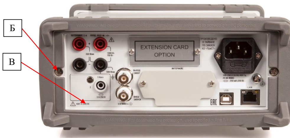
Рисунок 2 – Схема пломбировки от несанкционированного доступа (Б) и место нанесения заводского номера (В)
