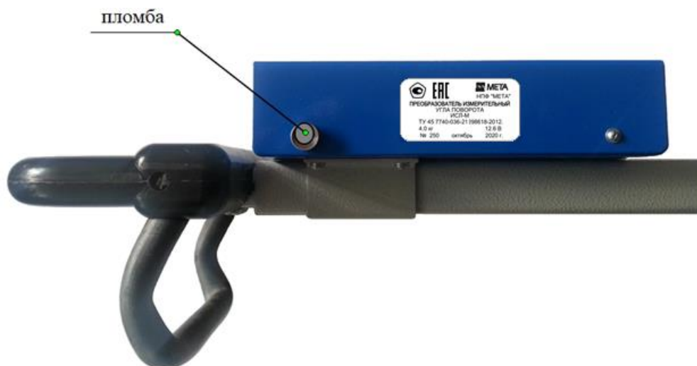
Рисунок 5 – Место пломбирования преобразователей измерительных угла поворота ИСЛ-М
