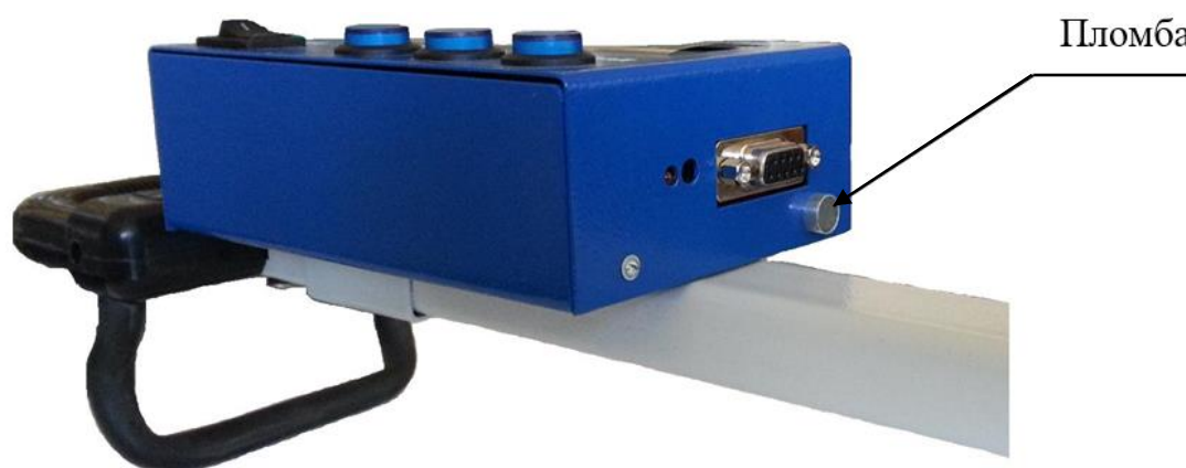
Рисунок 6 – Место пломбирования преобразователей измерительных угла поворота ИСЛ-М.01
