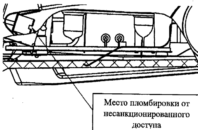
Рисунок 3.1 – Схема пломбировки от несанкционированного доступа
