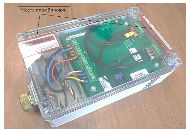
Рисунок 4 – Места пломбирования от несанкционированного доступа
