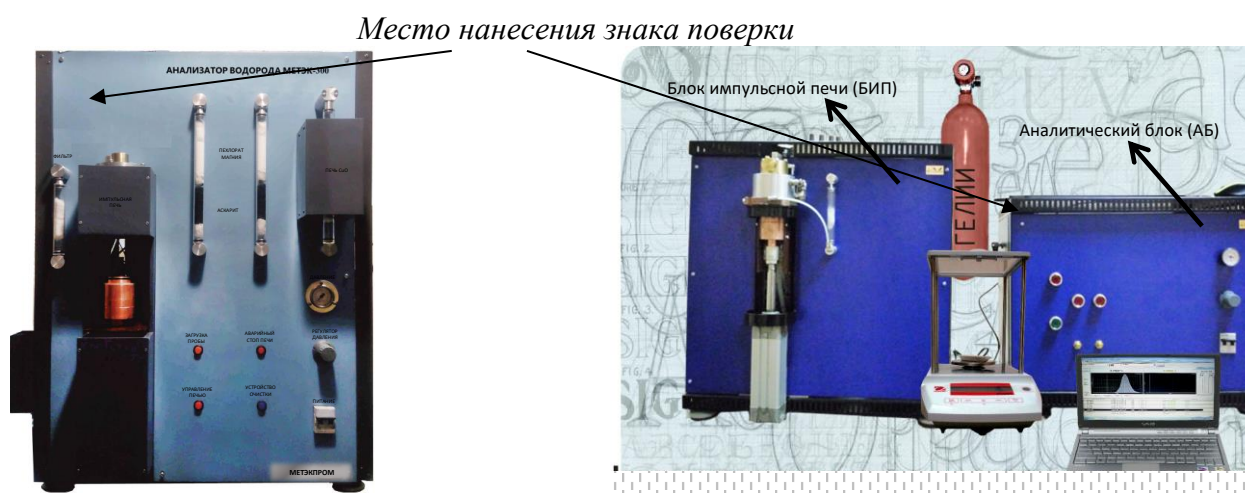
А -Исполнение 1: Моноблок (импульсная печь + аналитический блок)
