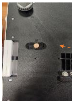
Рисунок 1 – Общий вид весов модели LS215-01-M и схема пломбирования от несанкционированного доступа
