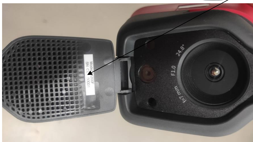
Рисунок 1 – Общий вид тепловизора и место нанесения заводского номера
