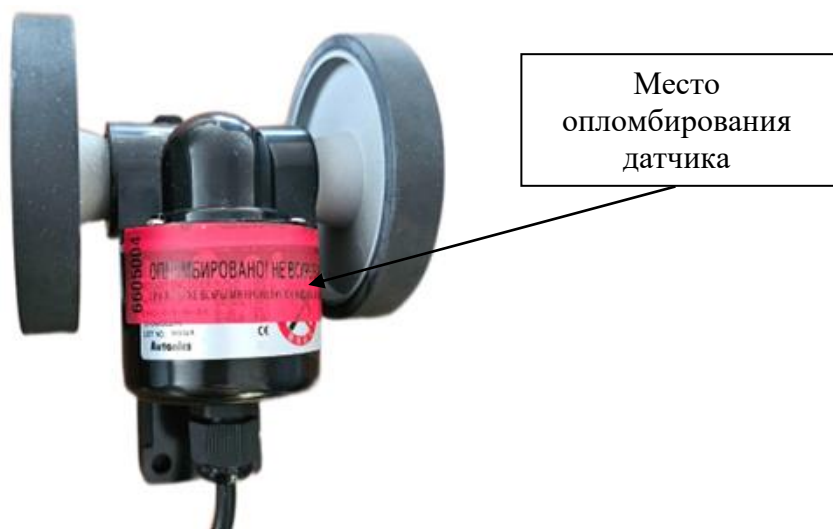
Рисунок 2 – Инкрементальный энкодер с двумя мерными колесами
