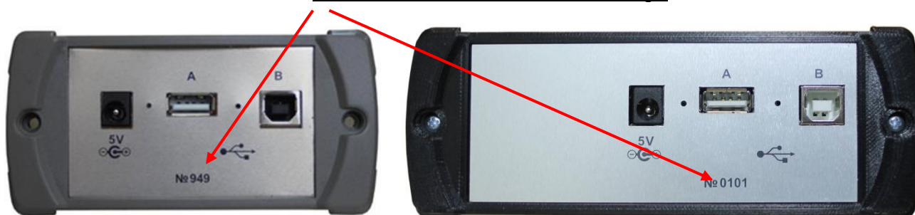
Рисунок 4 – Вид боковой панели (электрические разъемы)
