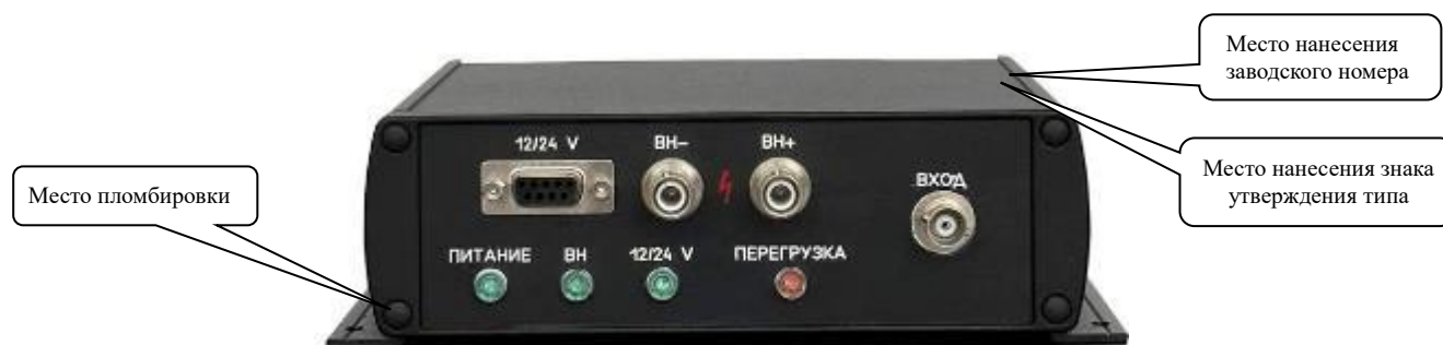
Рисунок 1 – Общий вид анализатора АМА-01И, обозначение мест нанесения знака утверждения типа и места нанесения заводского номера, схема пломбировки от несанкционированного доступа
