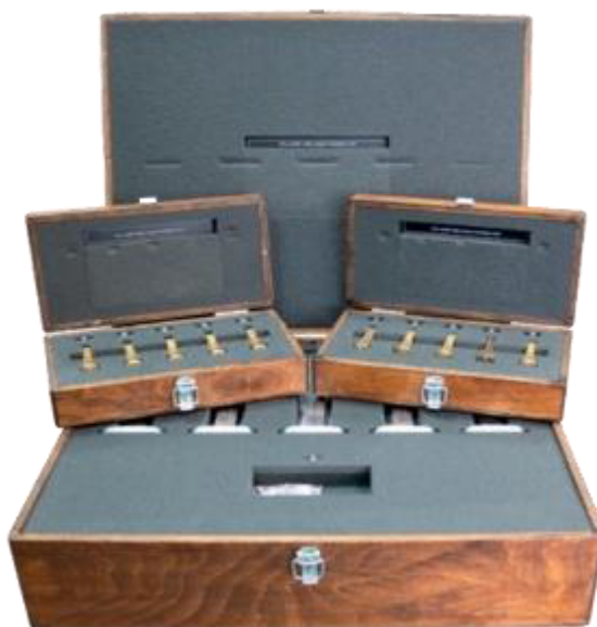
Рисунок 1 – Внешний вид наборов нагрузок волноводных КНВ
