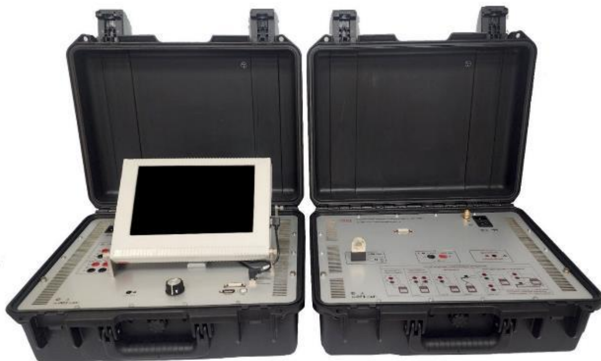
Рисунок 1 – Общий вид калибратора КЭВ-1 (блоки КЭВ-1Б и КЭВ-1У)
