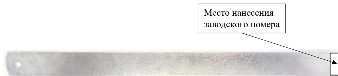
Рисунок 2 – Общий вид линейек: оборотная сторона линейек с указанием места нанесения заводского номера
