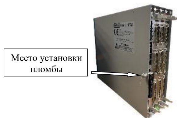
Рисунок 3 – Схема пломбировки ИБК
