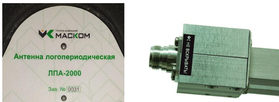
Рисунок 3 – Место пломбировки от несанкционированного доступа и нанесения заводского номера логопериодической антенны ЛПА–2000
