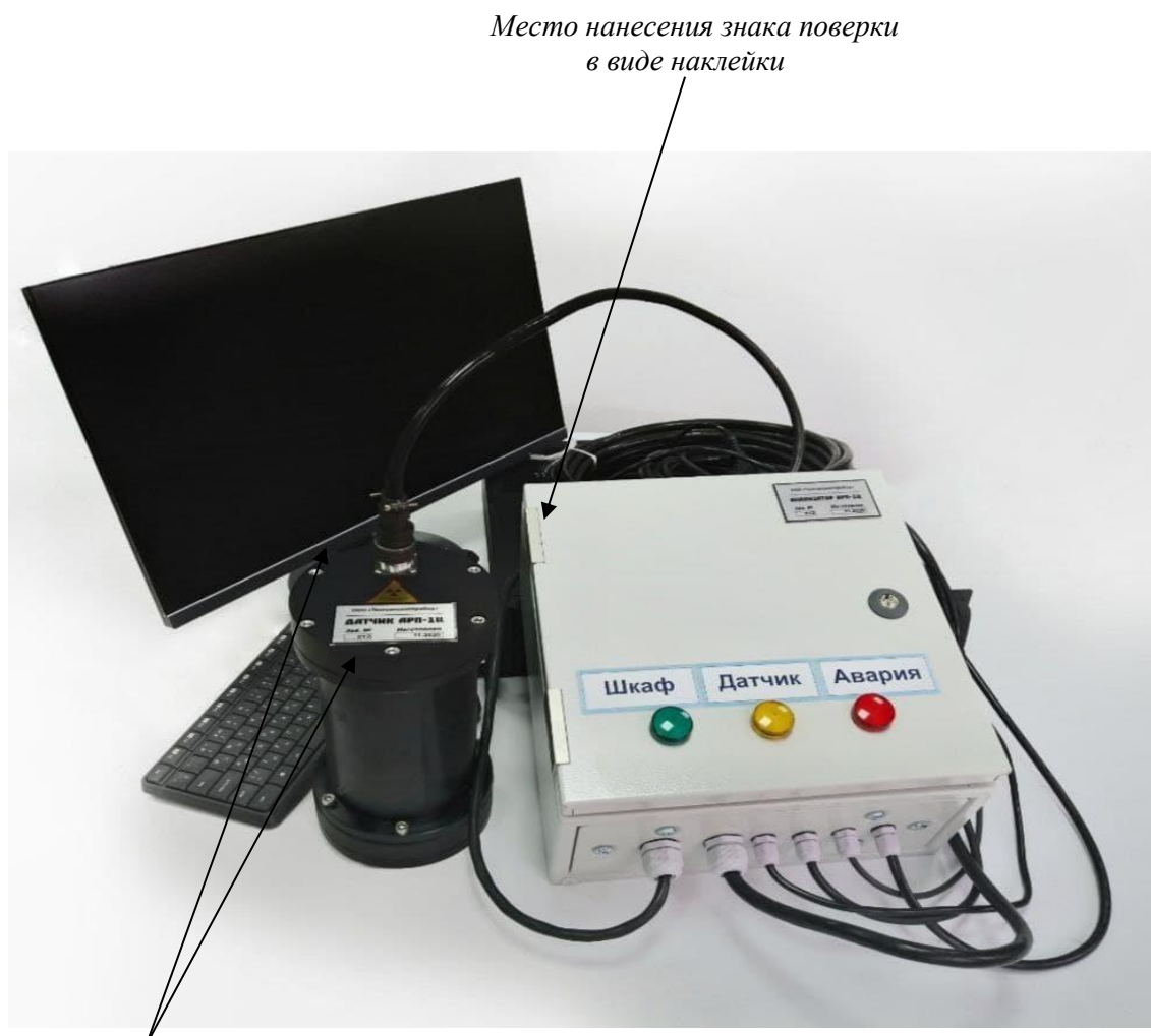
Рисунок 1 – Общий вид анализаторов АРП-1Ц (без системного блока управляющего компьютера), схема пломбировки от несанкционированного доступа и обозначение места нанесения знака поверки в виде наклейки
