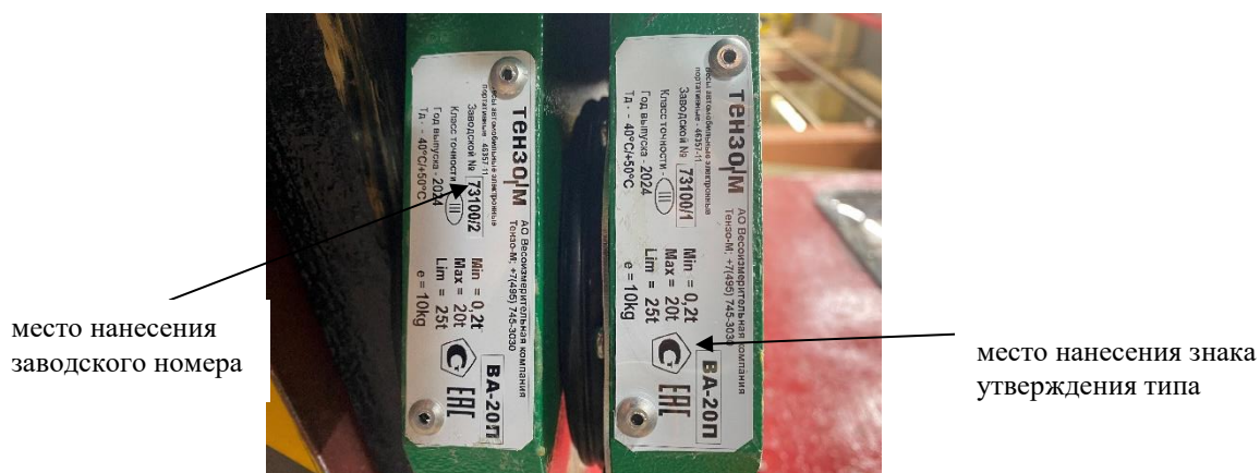
Рисунок 2 – Маркировка весов с указанием мест нанесения заводского номера и знака утверждения типа
