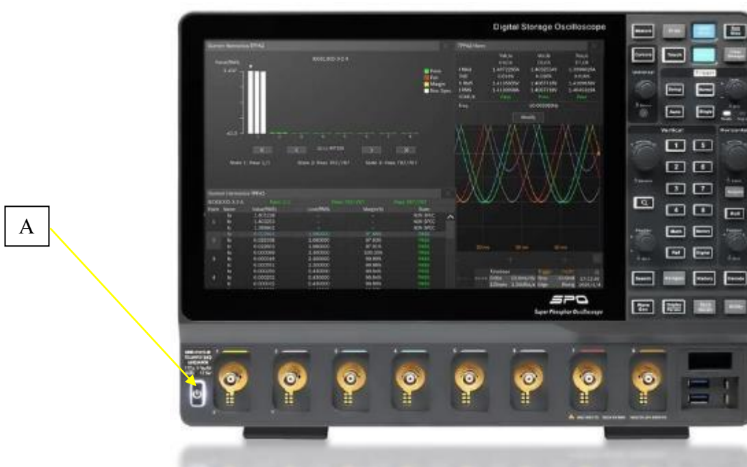
Рисунок 1 – Общий вид осциллографов (модификация 8 каналов) и место нанесения знака утверждения типа (А)
