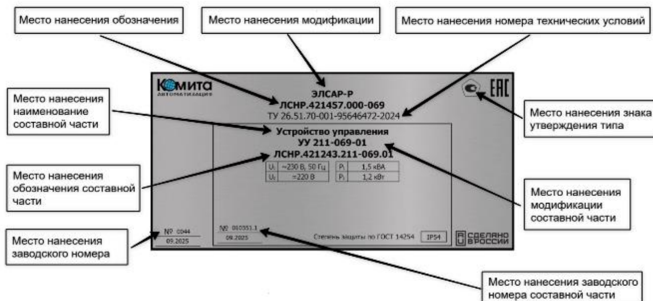
Рисунок 2 – Место нанесения заводского номера и знака утверждения типа
