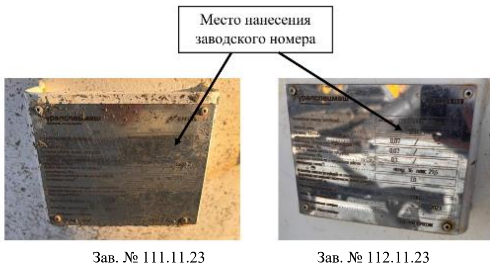
Рисунок 1 – Маркировочные таблички резервуаров
