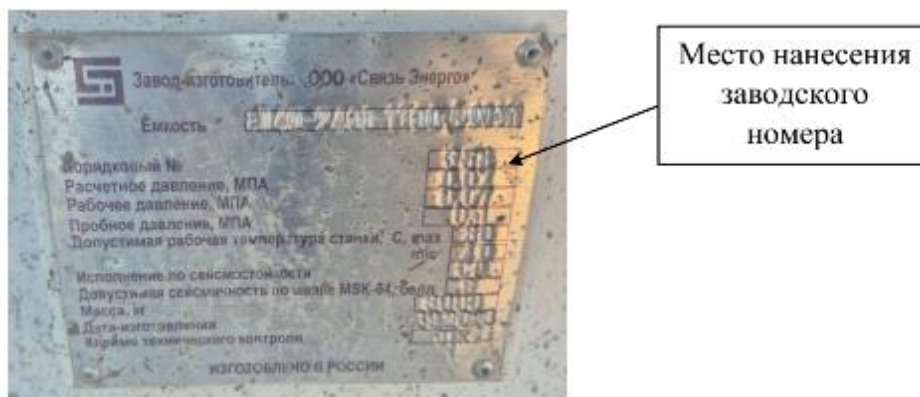
Рисунок 1 – Маркировочная табличка резервуара
