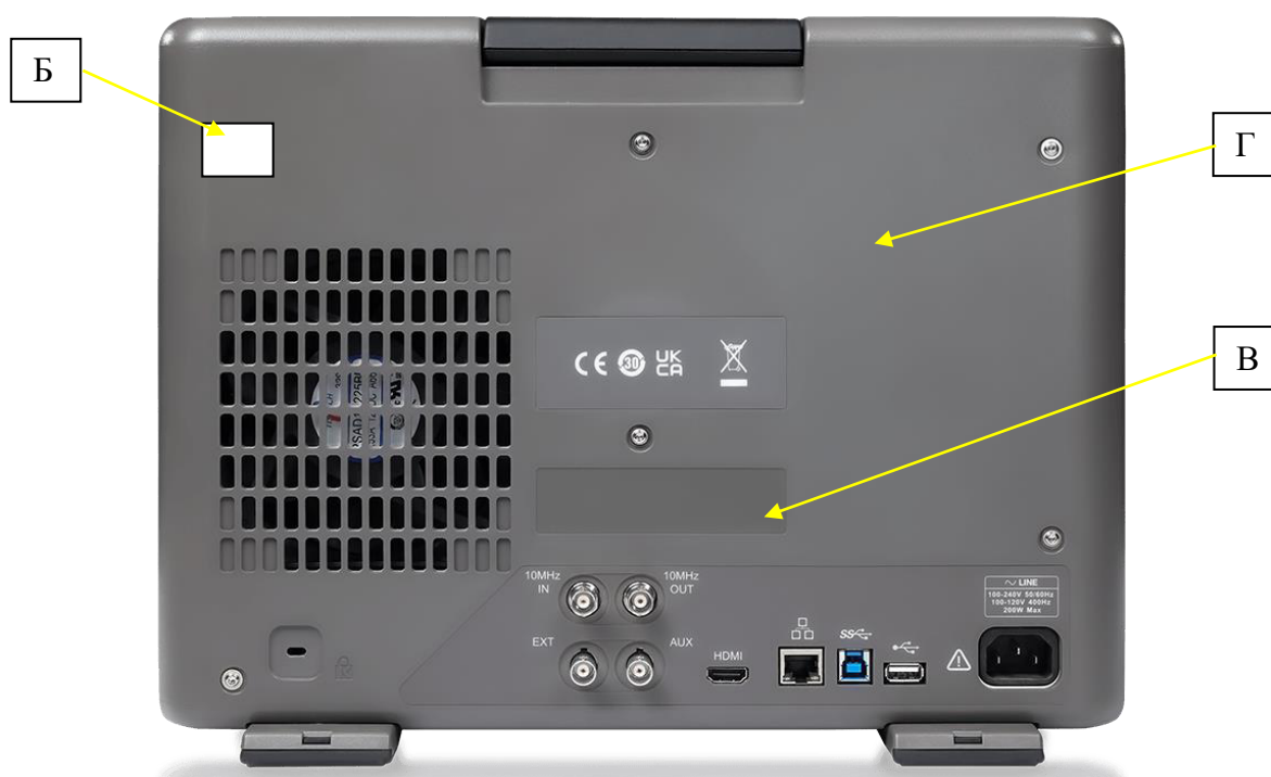
Рисунок 2 – Вид задней панели осциллографов, место пломбировки от несанкционированного доступа (Б), место нанесения серийного номера (В) и знака поверки (Г)
