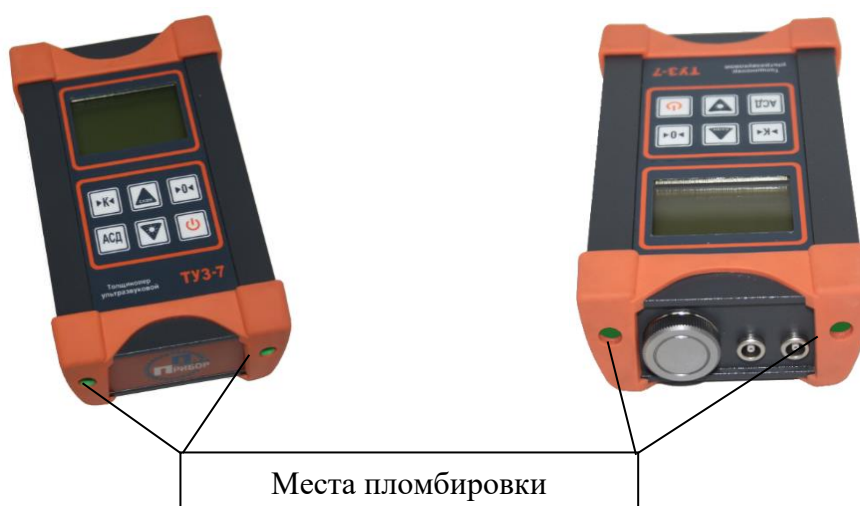
Рисунок 2 – Схема пломбировки от несанкционированного доступа
