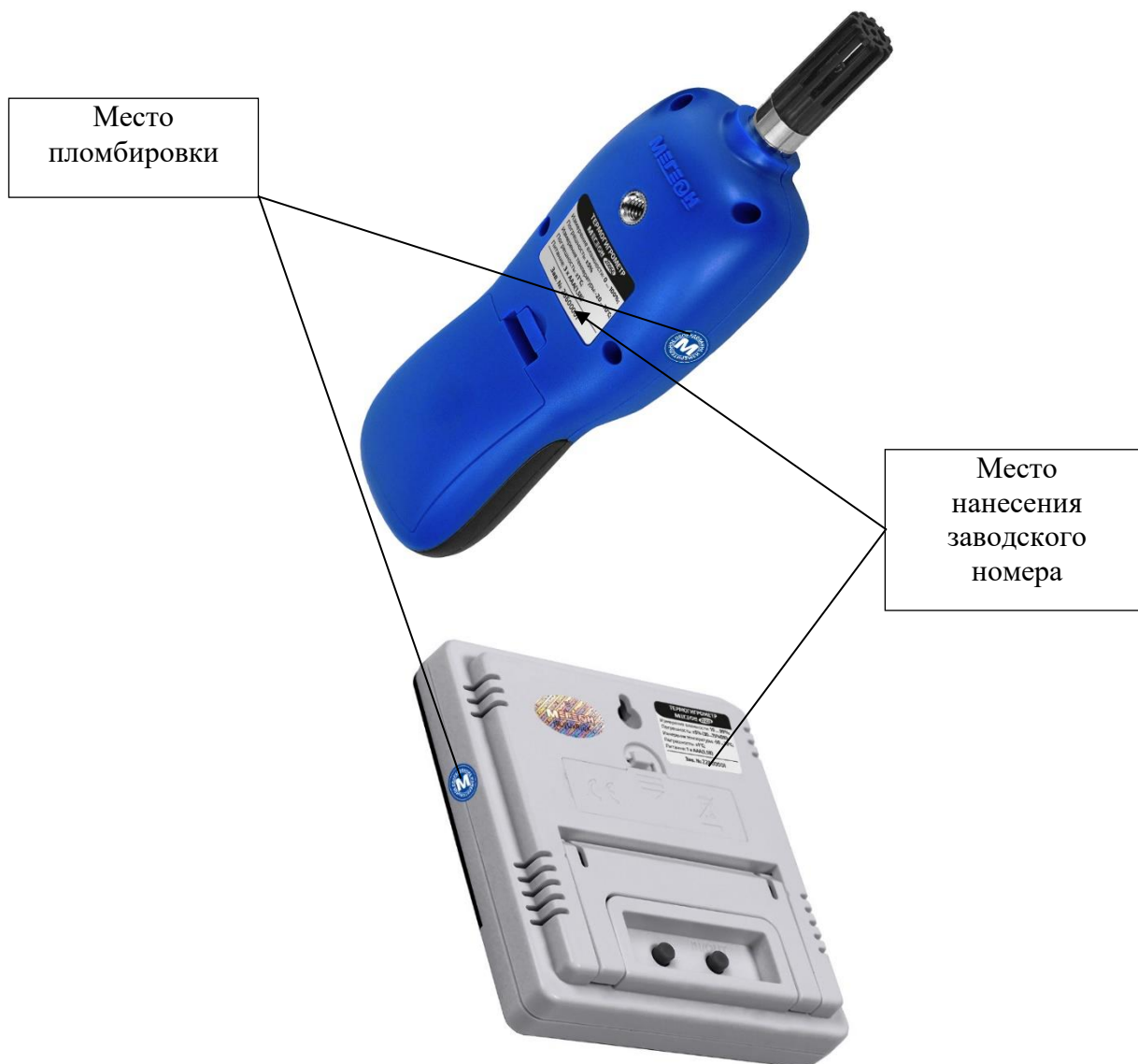
Рисунок 2 – Общего вида термогигрометра МЕГЕОН с указанием мест нанесения заводского номера и места пломбирования от несанкционированного доступа
