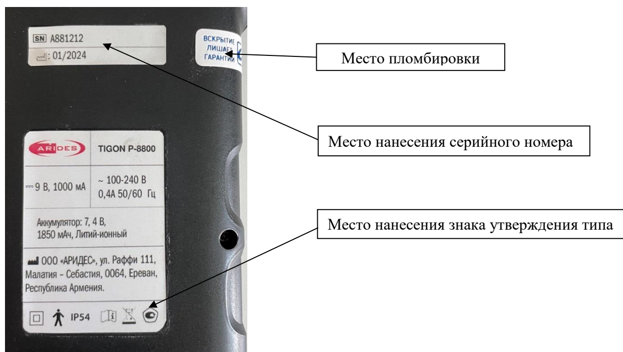
Рисунок 5 – Идентификационная табличка и место пломбирования корпуса анализаторов исполнения М-8800
