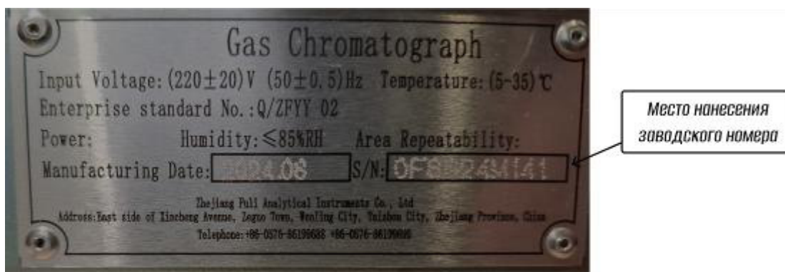
Рисунок 4 – Идентификационная табличка хроматографов газовых F80 с указанием места нанесения заводского номера
