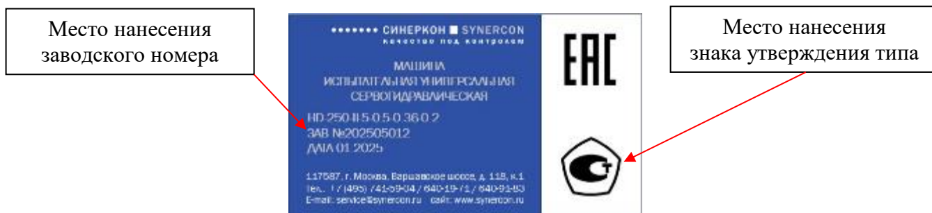
Рисунок 8 – Обозначение места нанесения заводского номера и знака утверждения типа на примере маркировочной таблички машины HD-250-II
