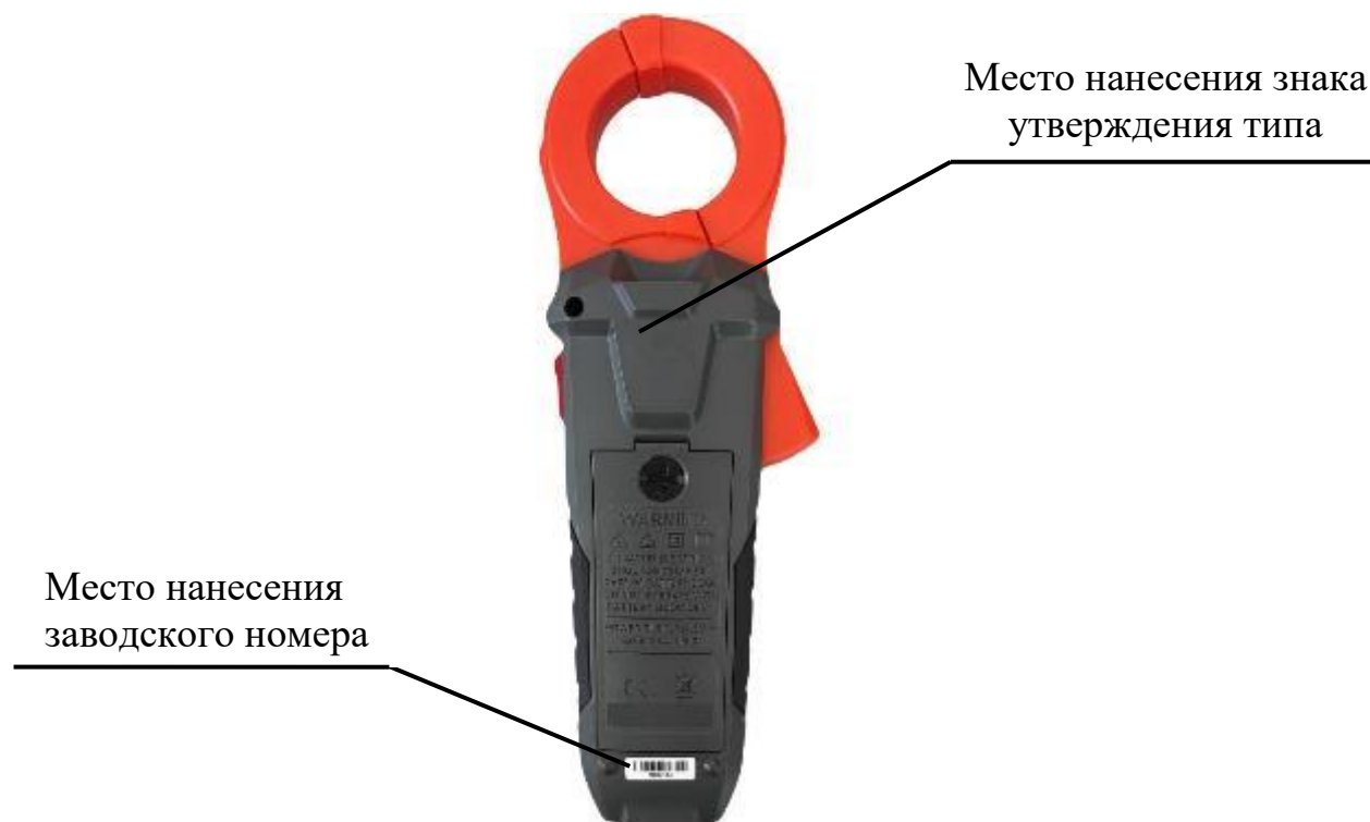
Рисунок 10 – Клещи модификации СМР-100 с указанием места нанесения знака утверждения типа, места заводского номера
