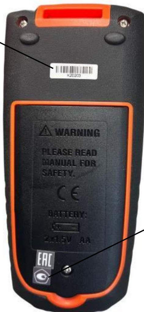
Рисунок 8 – Клещи модификации CMP-3kR с указанием места нанесения знака утверждения типа, места заводского номера
