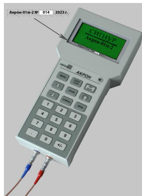
Рисунок 3 – блок электронный БЭ-2м (портативное исполнение для аудита)
