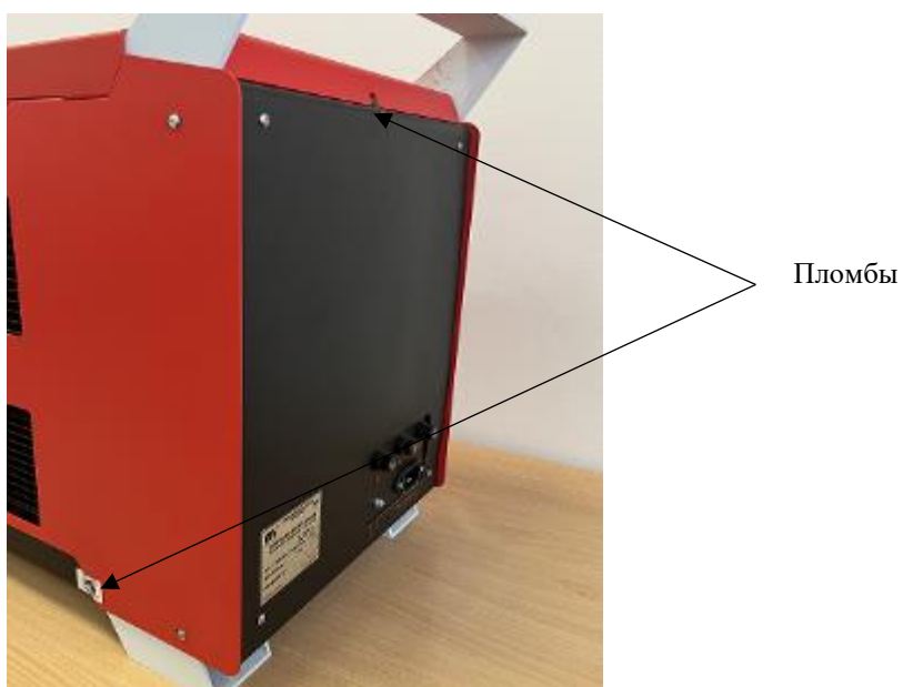
Рисунок 2 – Схема пломбирования излучателя от несанкционированного доступа
