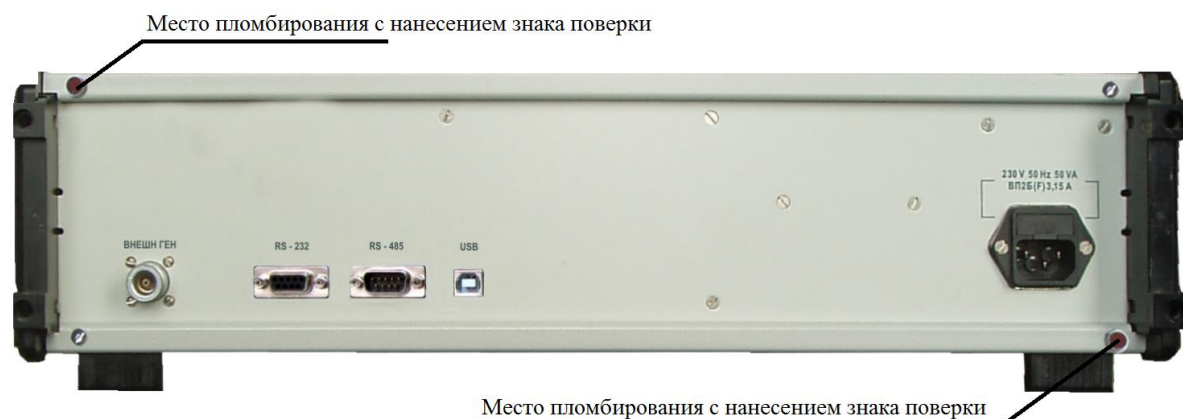
Рисунок 2 – Схема пломбирования от несанкционированного доступа
