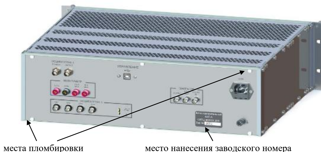
Рисунок 2 – Места пломбировки и нанесения заводского номера КИТ-А
