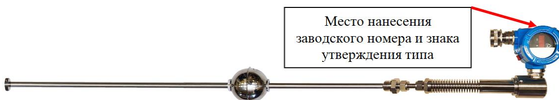
Р и с у н о к 6 – Уровнемеры ВЕКТОР10XXX-0-X-T1, ВЕКТОР11XXX-0-X-T1, ВЕКТОР12XXX-0-X-T1, ВЕКТОР10XXX-0-X-T2, ВЕКТОР11XXX-0-X-T2, ВЕКТОР12XXX-0-X-T2 с жестким измерительным элементом
