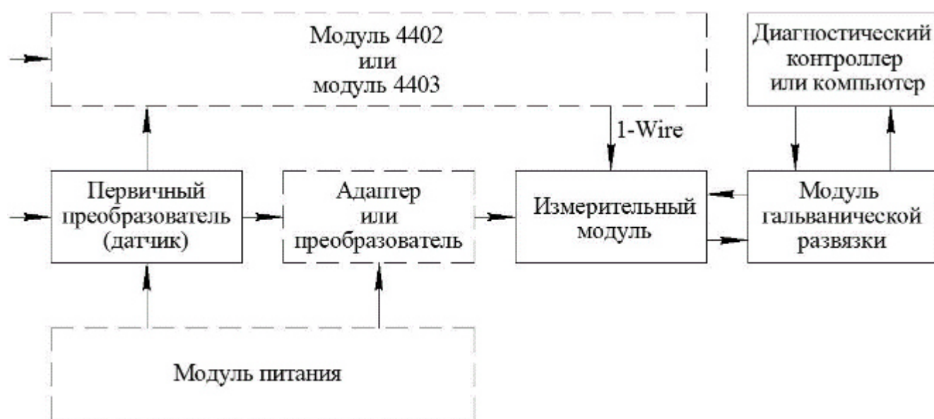
Р и с у н о к 1 – Структурная схема измерительного канала
