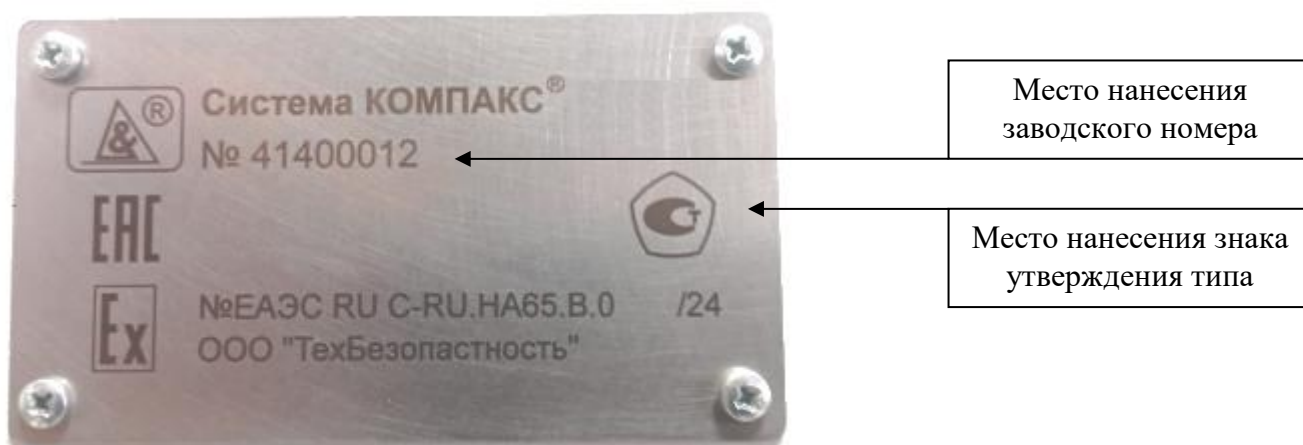
Р и с у н о к 16 – Места нанесения заводского номера и знака утверждения типа
