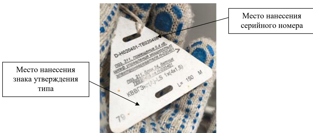
Рисунок 1 – Маркировочная табличка терморезисторов с указанием места нанесения серийного номера и места нанесения знака утверждения типа
