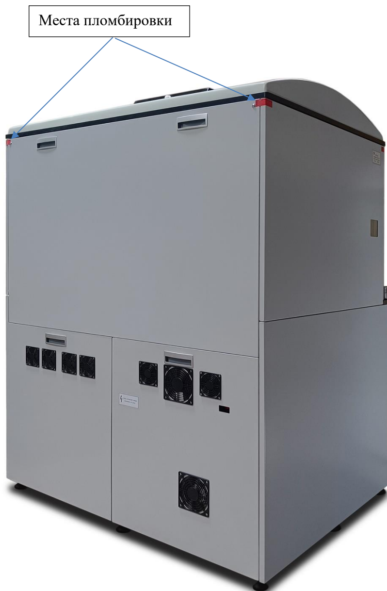
Рисунок 2 – Общий вид спектрометра рентгеновского многоканального СРМ-35 со стороны задних панелей
