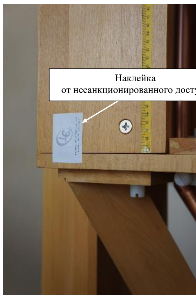
Рисунок 3 – ЭМП-1. Вид сбоку. Схема пломбировки от несанкционированного доступа
