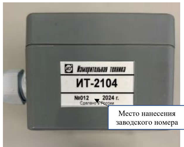
Рисунок 6 – Общий вид боковой панели преобразователей конструктивного исполнения ИТ-2104 с указанием места и формата нанесения заводского номера
