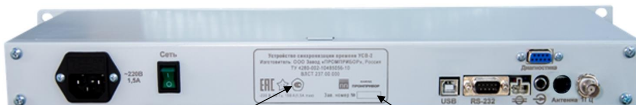
б) стоечное исполнение ВЛСТ 237.00.000, вид сзади (с разъемом для аналоговой антенны)
