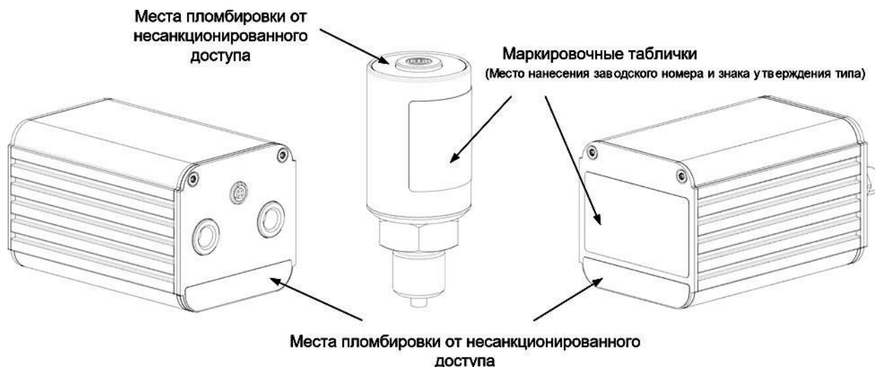
Рисунок 2 – Схема пломбировки преобразователей от несанкционированного доступа и расположение маркировочных табличек
