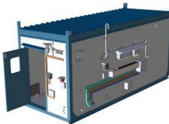
Рисунок 2 – Общий вид блока-контейнера DB1
