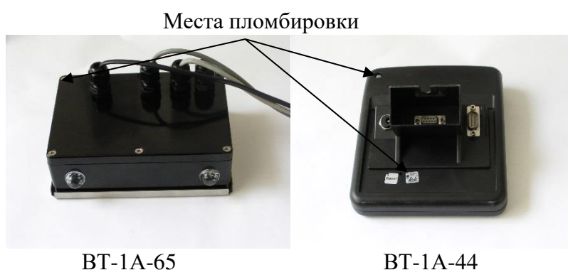
Рисунок 6 – Места пломбировки от несанкционированного доступа весов в исполнении П с индикаторами BT-1A-65 и BT-1A-44
