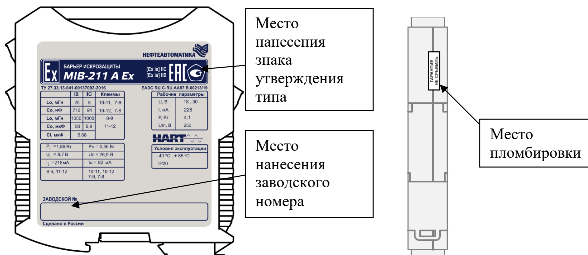
Рисунок 11 – Места нанесения знака утверждения типа, заводского номера и пломбировки
