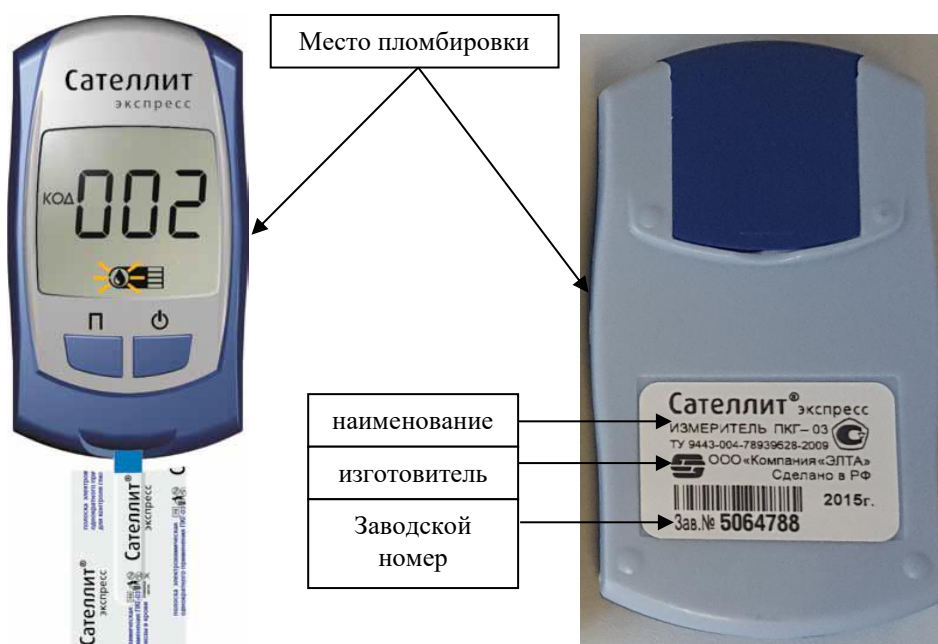
Рисунок 2 – Схемы пломбировки от несанкционированного доступа и маркировки
