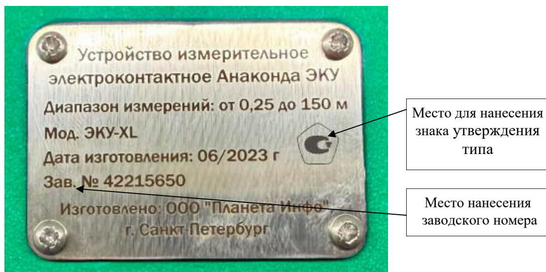
Рисунок 4 – Маркировочная табличка устройства измерительного электроконтактного Анаконда ЭКУ модификации ЭКУ-XL с указанием места нанесения знака утверждения типа и заводского номера
