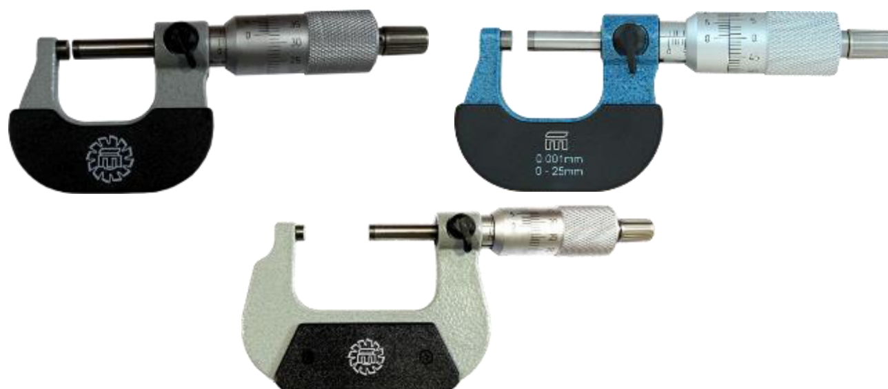
Рисунок 3 – Общий вид микрометров с отсчетом показаний по шкалам стебля и барабана с нониусом
