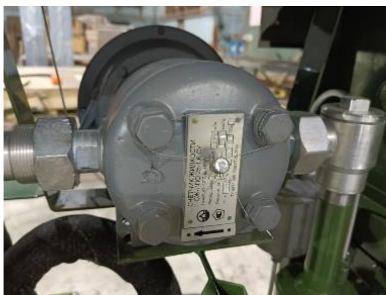
Рисунок 2 – Схема пломбировки счётчика жидкости колонок
