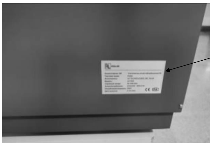
Рисунок 2 – Место нанесения серийного номера на спектрометры атомно-абсорбционные LT
